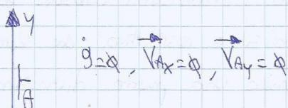
5) CERNIERA STABILE  $\rightarrow$  Collega due corpi rigidi. Nel punto  $A$ , ci può essere una rotazione fra i corpi, ma essi restano in contatto.
